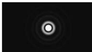
Fig. 9.- Figura de difracção típica, observável com um telescópio com 33% de obstrução (amplificação de cerca de 2,4x por milímetro de abertura). Num telescópio sem obstrução (refractor), o primeiro anel de difracção é mais tênue.
