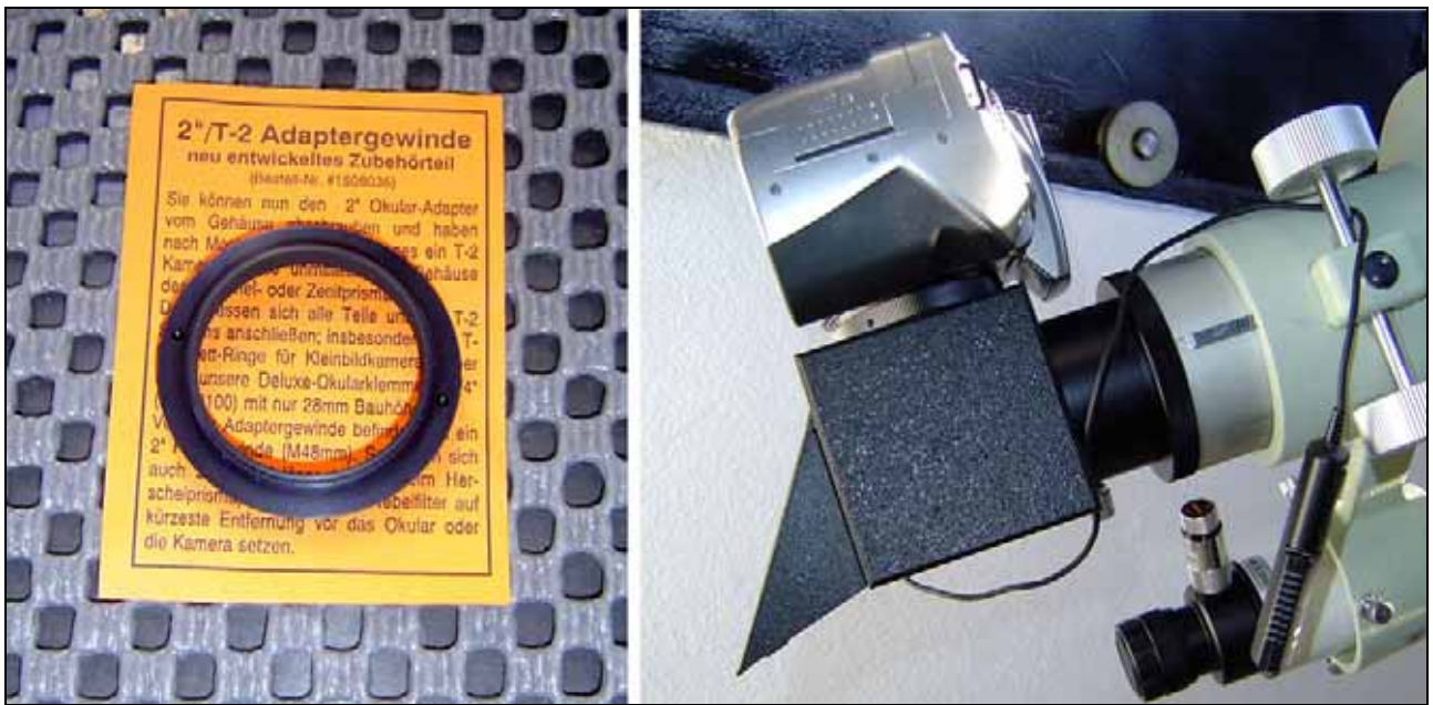
Figura 3- Anel que permite adaptar uma DSLR a um prisma Herschel Baader. Pedro Ré (2005).
